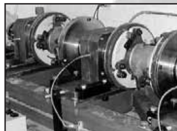
Prueba a escala real de dos acoplamientos generadores de viento bajo condiciones extremas de desalineación.
